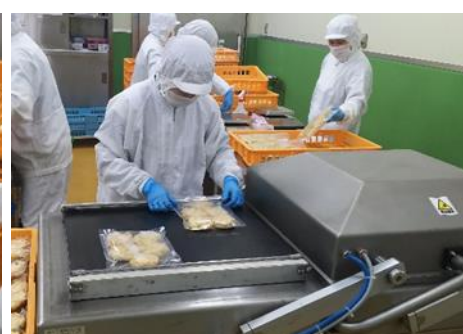
⑨ 食感を損なわないように調整した真空レベルでパック。
