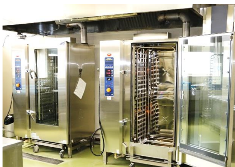
最大 20 段同時調理可能な大型のスチームコンベクションを 2 基備えています
