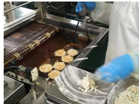
③ ②で出来たタネを計量し、油中の3連の丸枠に投入。
