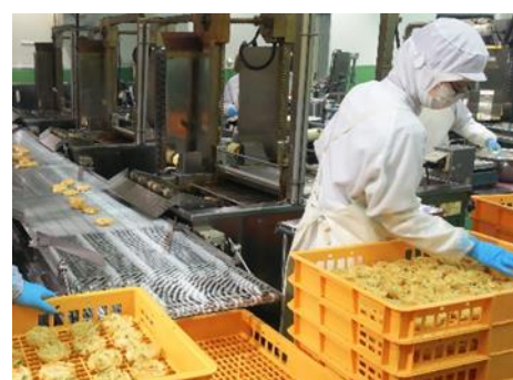
⑥ 計量・目視で規格外品排除し、番重に並べ、粗熱をとる。
