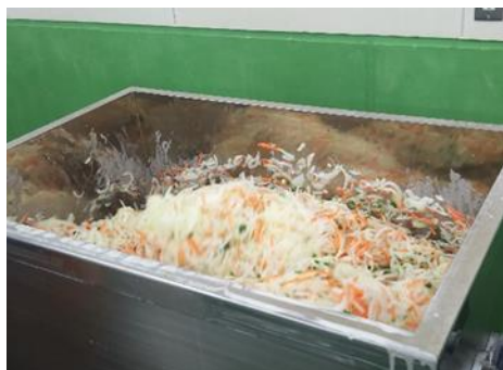
① 攪拌機でカット済の玉葱など野菜を混合。
