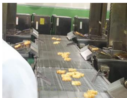
⑤ 枠を外すと油の中を一定時間進み、揚げ網のコンベアに乗る。
