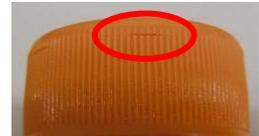
ちなみにペットボトル本体の形ですが、お茶やスポーツドリンクで四角形・長方形の物が存在しますが、炭酸飲料は全て円型です。なぜ角形の炭酸飲料が存在しないのか。これは角形では炭酸の圧力に耐えられないためです。さらにちなみにキャップ天面の丸いくぼみや、側面の他に比べて短いギザは、キャップをする際の位置決め用です。
