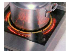
火が見えないので調理中(加熱中)であることがわかりにくい。最近では使用中にLEDが点灯するタイプも。
