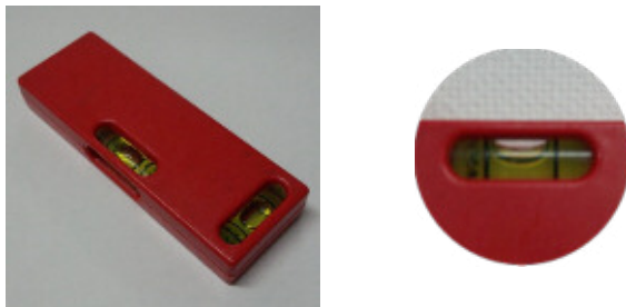
写真は簡易的な気泡管水準器。気泡が目盛中央に来た時が水平です。
